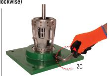
Place BOTTOM STAGE IMPELLER on Shaft
